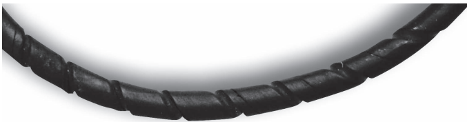
Bild 9.10 Verdrehter O-Ring mit spiralförmigen Markierungen
