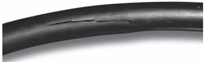
Bild 9.12 Oberflächenzerstörung durch explosive Dekompression
