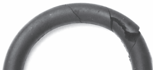
Bild 9.11 Verdrehter O-Ring mit Einschnitten in der O-Ring-Oberfläche
