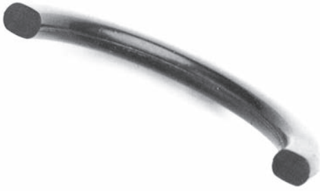
Bild 9.9 Schadensbild durch hohe bleibende Verformung (Compression Set)
